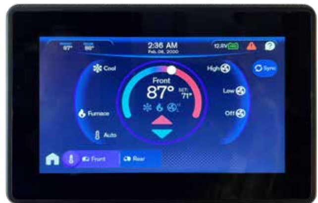
Panneaux de commande multiplex typiques avec affichage de la régulation du climat
