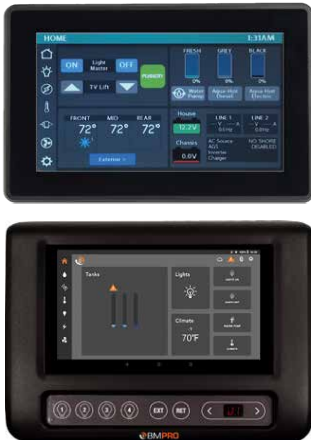
Panneaux d'écran tactile typiques ; Firefly (ci-dessus) et BMPPro (ci-dessous). Les fonctionnalités varient en fonction du modèle et du plan de surface de l'autocaravane.
