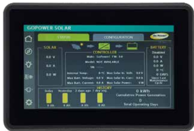
Contrôle solaire intégré. Illustration de l'écran tactile Firefly (ci-dessus) et de l'écran tactile BMPPro (ci-dessous). Bien que les écrans de menu aient une présentation différente, les deux permettent la supervision de la charge solaire et l'état de charge de la batterie.
