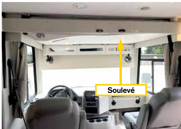
Couche supérieure Euroloft en position relevée ou rangée (ci-dessus). Couche EuroLoft en position abaissée (ci-dessous).
