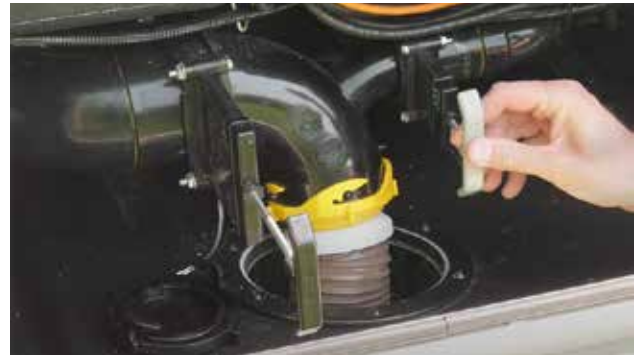
Fermeture des vannes d'extrémité ; fermez d'abord la vanne grise, puis la vanne noire.
