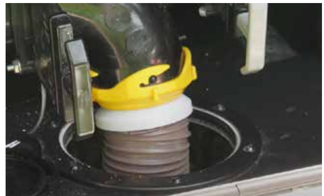
Tuyau d'égout raccordé à la sortie des eaux usées de l'autocaravane.
