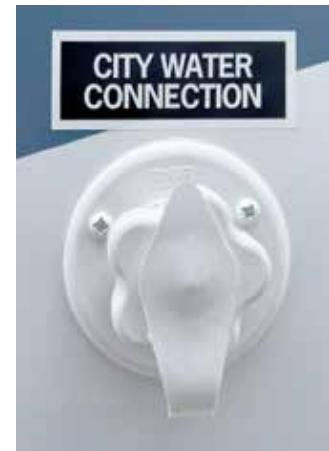
Raccordement de remplissage d'eau municipal typique
