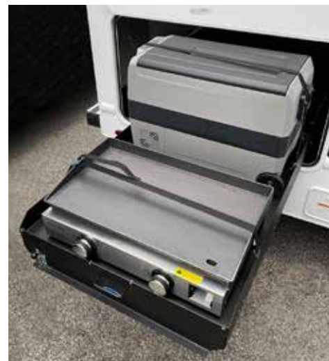
Plaque chauffante portable GPL et un réfrigérateur 12 volts montés sur un plateau coulissant à l'arrière.
