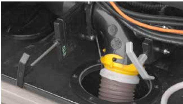
Vanne d'extrémité du réservoir d'eaux usées en position OUVERTE.
