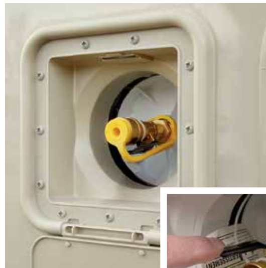
(Au-dessus) Orifice de raccord de propane externe typique. (Droite) vanne d'arrêt manuel.
