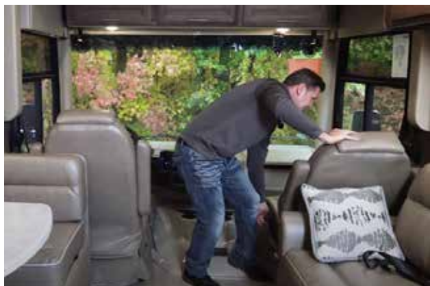
Figure 2. Rabattre d'abord les deux sièges avant, puis abaisser le lit électrique avant.
