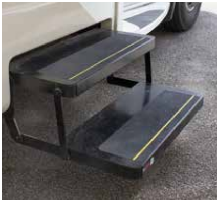
Marchepied électrique typique, avec une ou plusieurs marches, selon le modèle d'autocaravane.
