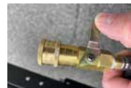
Plaque chauffante à 2 brûleurs, raccord rapide de gaz et flexible de gaz avec vanne intégrée.
